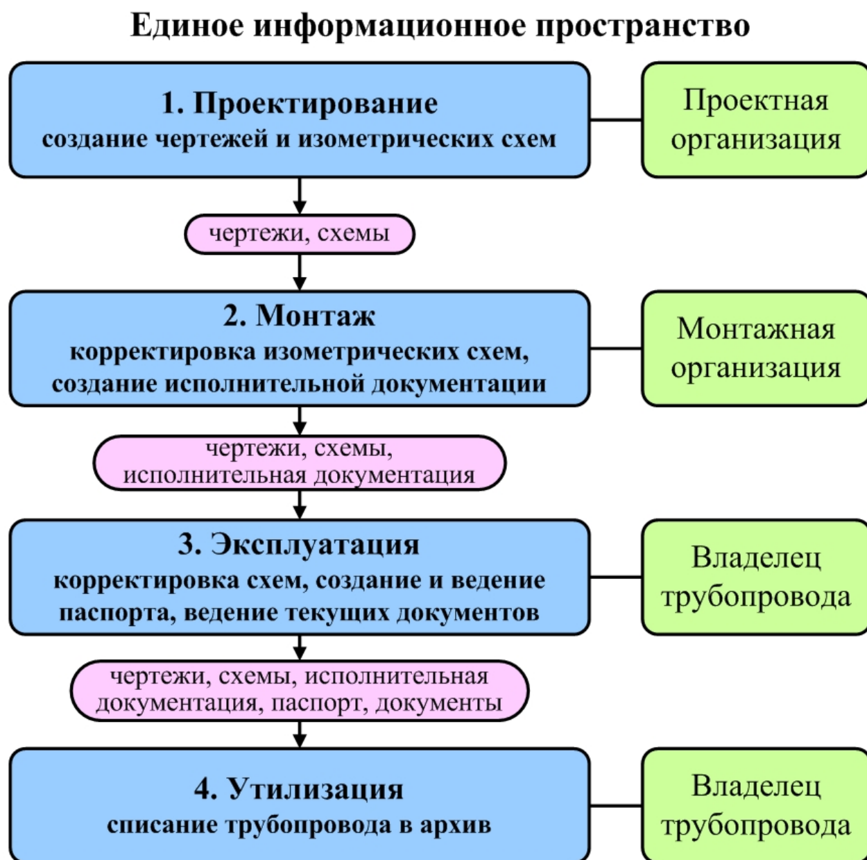
Рис. 1. Принципиальная схема процесса информационного сопровождения трубопроводов
